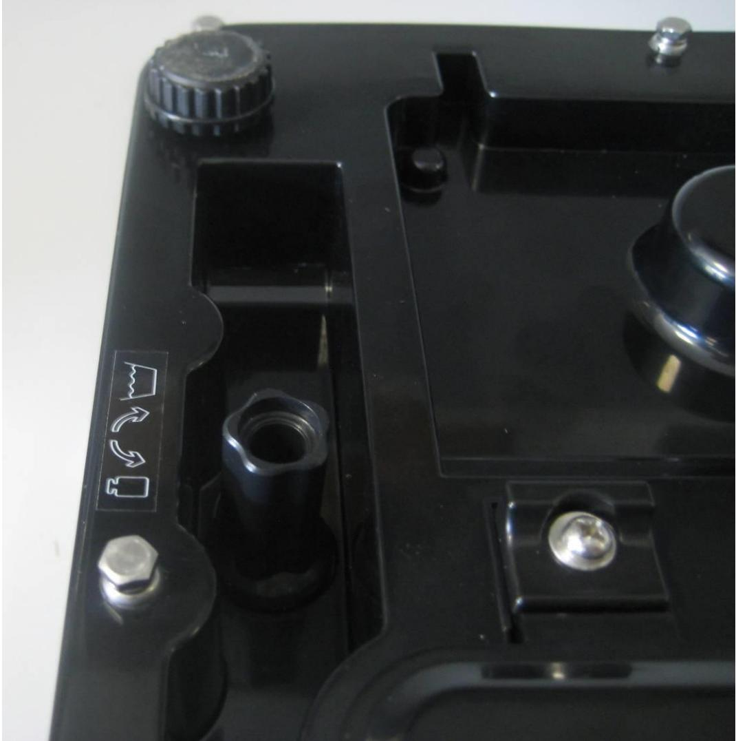
c) Nivellieren Sie die Waage mittels der Stellfüße bis die Libelle im Zentrum ist. Ein stabiler Standort der Waage ist sehr wichtig.
