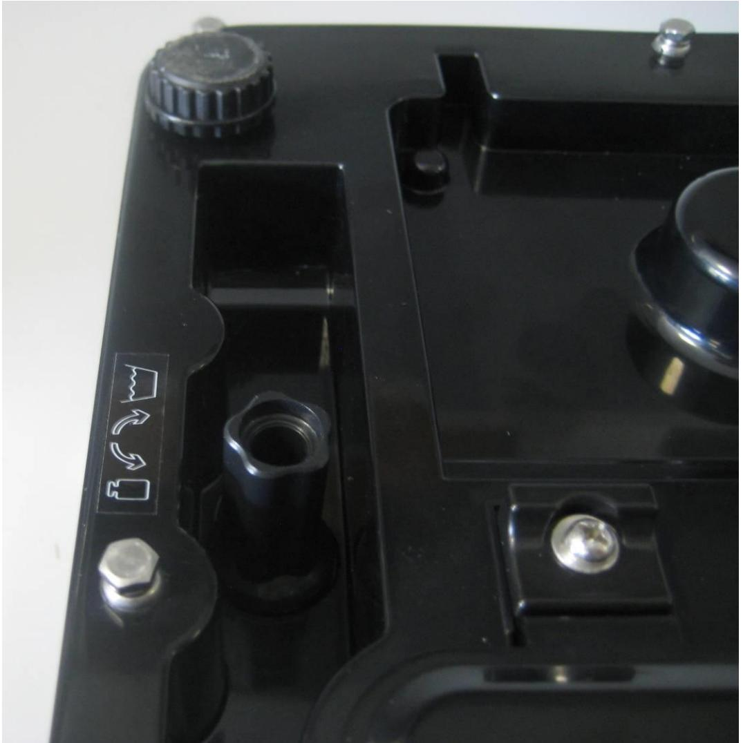
c) **Livellare la piattaforma** agendo sui piedini a vite. Riveste molta importanza la stabilità della piattaforma.
